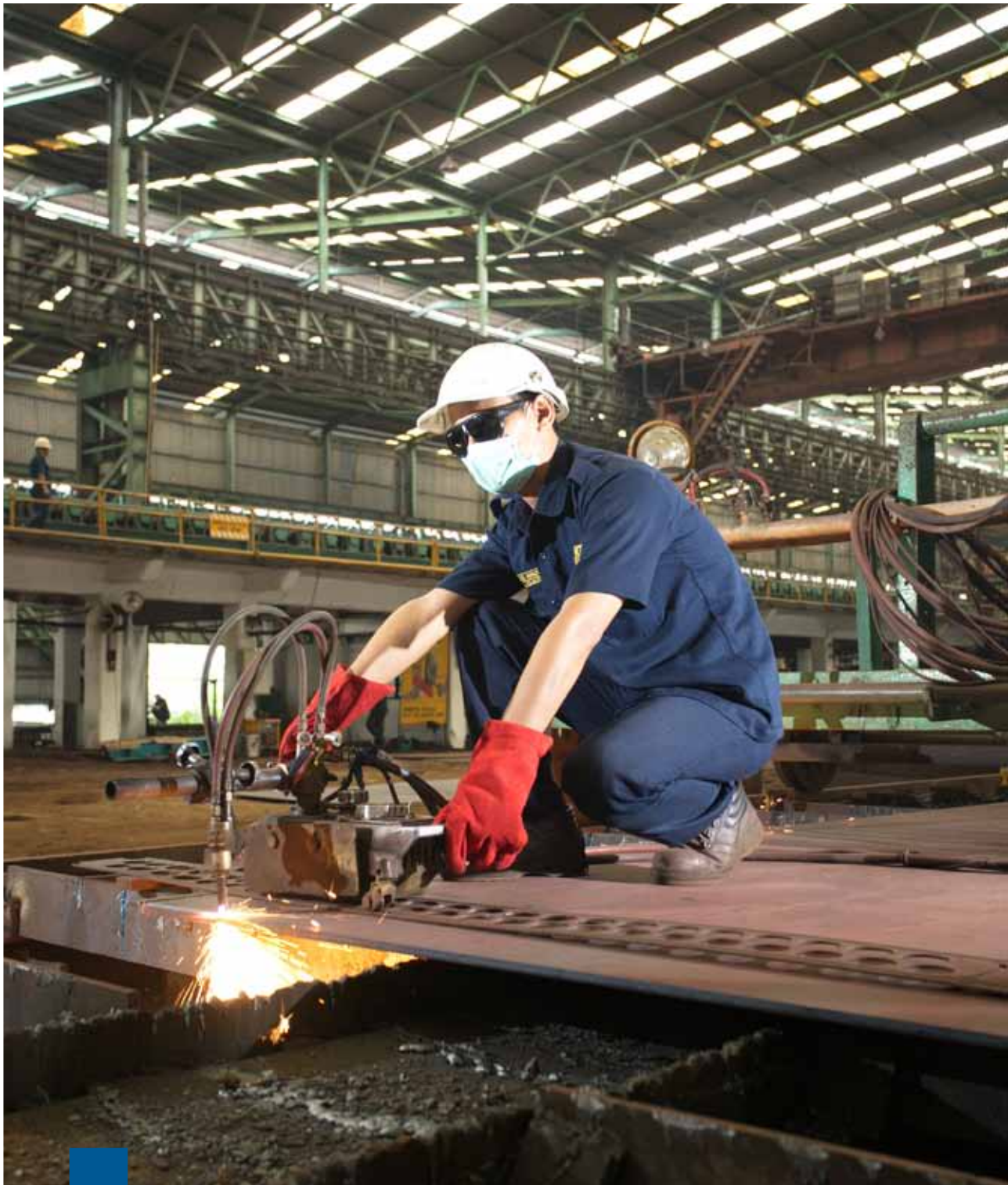
PEMOTONGAN PLAT DENGAN LAS PLATE FLAME CUTTING
